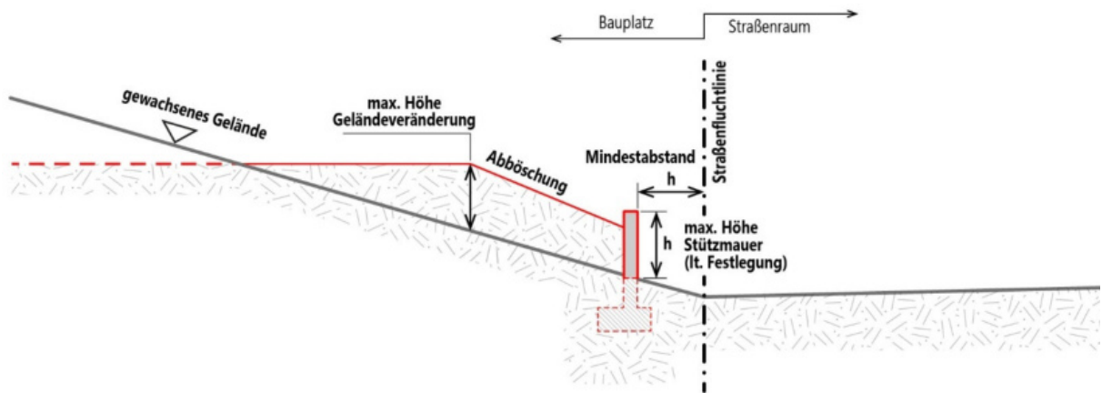
Abbildung 15: Systemskizze zur Darstellung von Gelände-/Niveauveränderungen und Stützmauern im Falle von Abgrabungen sowie allfälligen Mindestabständen zu Grundstücksgrenzen bzw. Straßenfluchtlinien (zu §13 Abs. 4 der ggst. VO)
