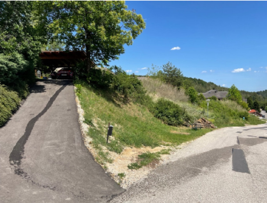
13: Am Hauerschlüssel mit Blick Richtung Osten; vermutlich aufgrund der markanten Geländeneigung wurde die vordere Baulinie in der Urfassung des Bebauungsplans 10m von der Straßenfluchtlinie festgelegt; Hauszufahrten, wie in der vorliegenden Situation werden in diesem Bereich zur Höhenüberwindung notwendig
