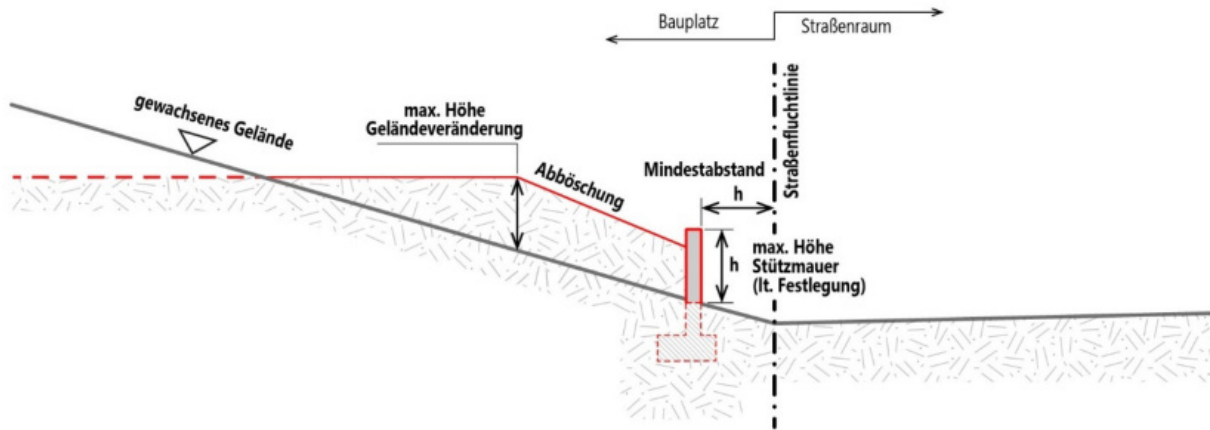
Abbildung 20: Systemskizze zur Darstellung von Gelände-/Niveauperänderungen und Stützmauern im Falle von Abgrabungen sowie allfälligen Mindestabständen zu Grundstücksgrenzen bzw. Straßenfluchtlinien (zu §13 Abs. 4 der ggst. VO)
